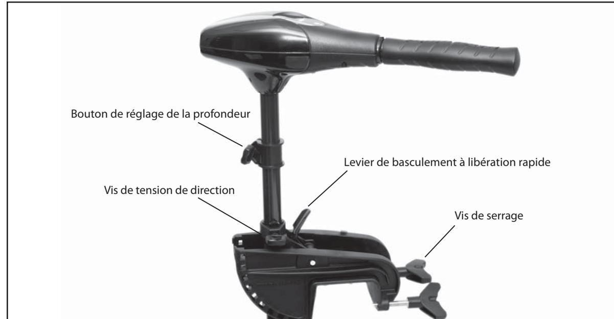
**AVERTISSEMENT :** Lors du hissage/de l'abaissement du moteur ou de l'utilisation du mécanisme de basculement, tenir les doigts à l'écart de tous les points de pivot et charnières, et de toutes les pièces en mouvement.
